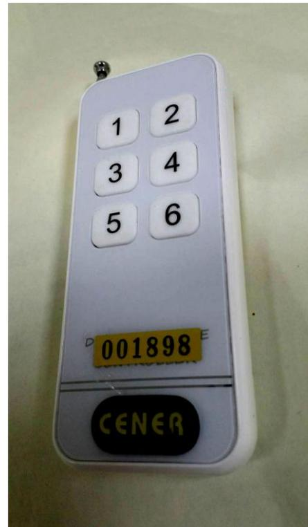
**輸出方式：**SHYNN-JD6L 有三種輸出方式：信號互鎖、信號非鎖、信號自鎖
